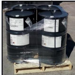
Incorrecta forma de paletizado (carga fuera del pallet)
